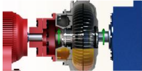
شکل (7): شماتیک کوپلینگ هیدرولیکی و محل قرار گیری آن
